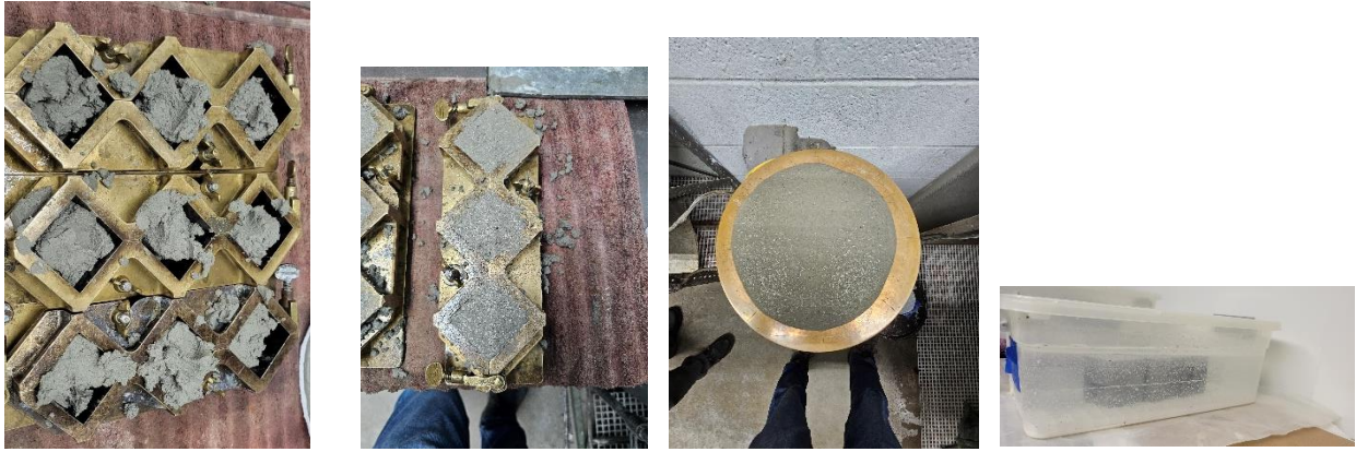
(a) (b) (c) (d) Fig. 1. (a) & (b) Cubes being prepared (c) Flow test (d) Cubes immersed in lime water
