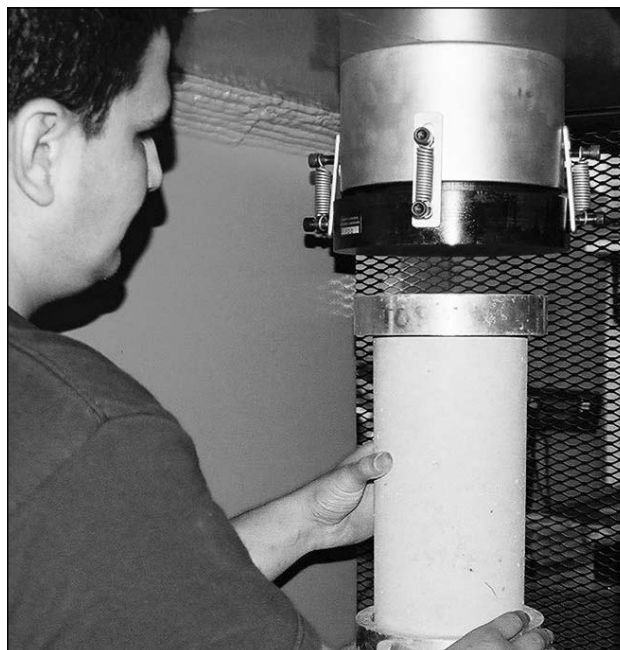
Ensayo de Concreto de Alta Resistencia
