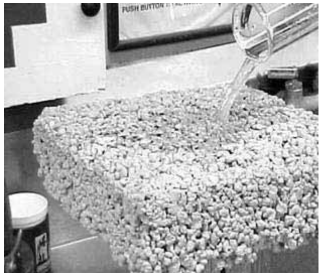
Figura 1: El Concreto Permeable permite la percolación de aguas lluvias.
