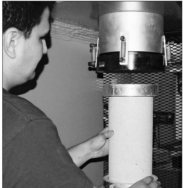
Ensayo de Concreto de Alta Resistencia
